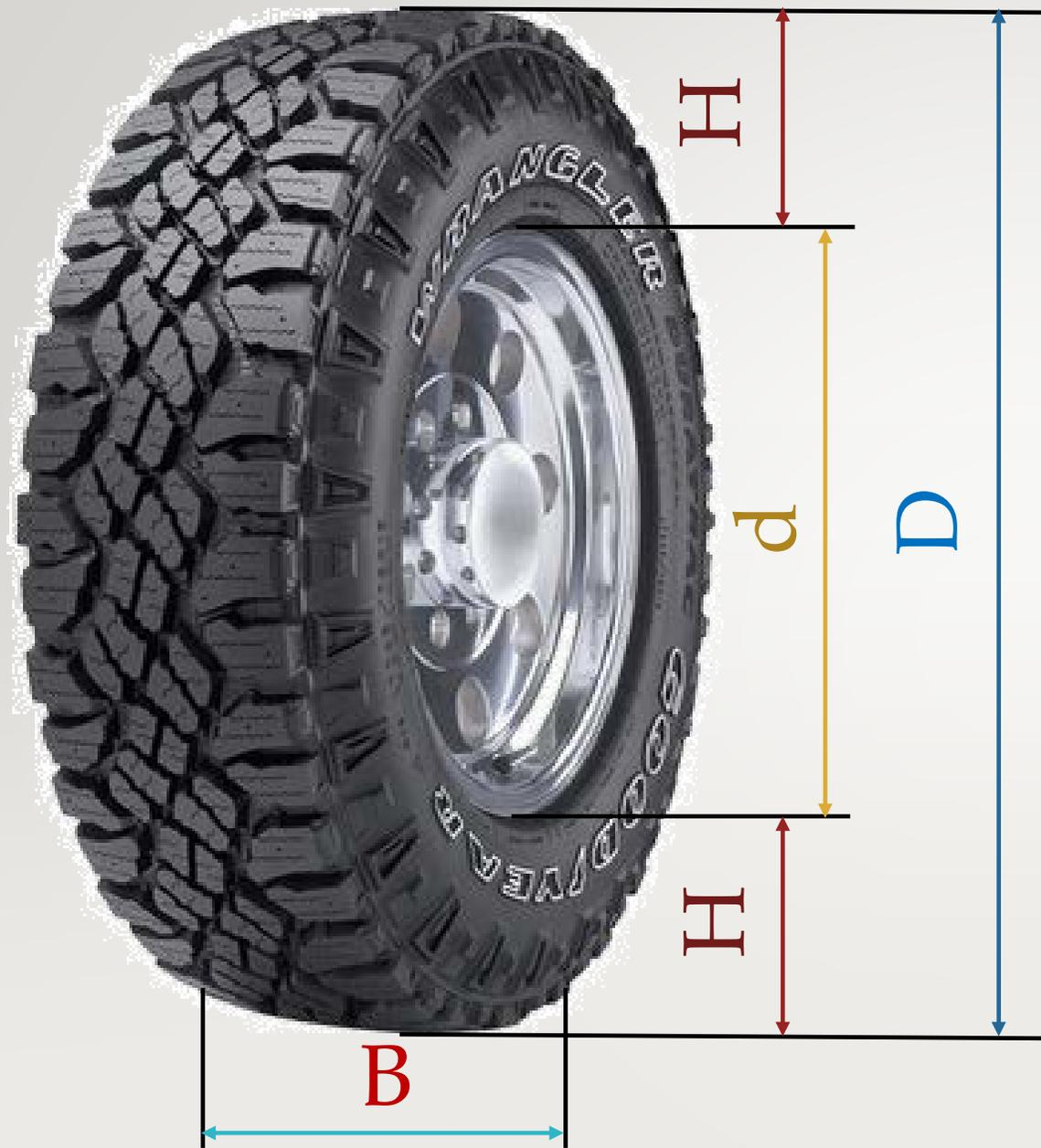
**B** – ширина протектора (ширина шины), в мм
